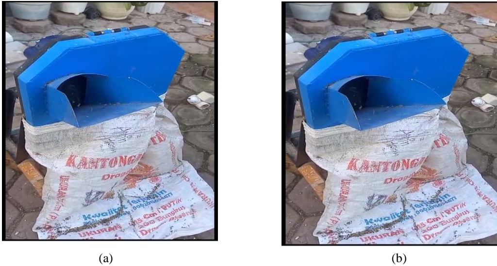
Gambar 8. Mesin penghalus kompos kering (a) dan Cara memasukkan kompos dalam mesin penghalus kompos (b)
